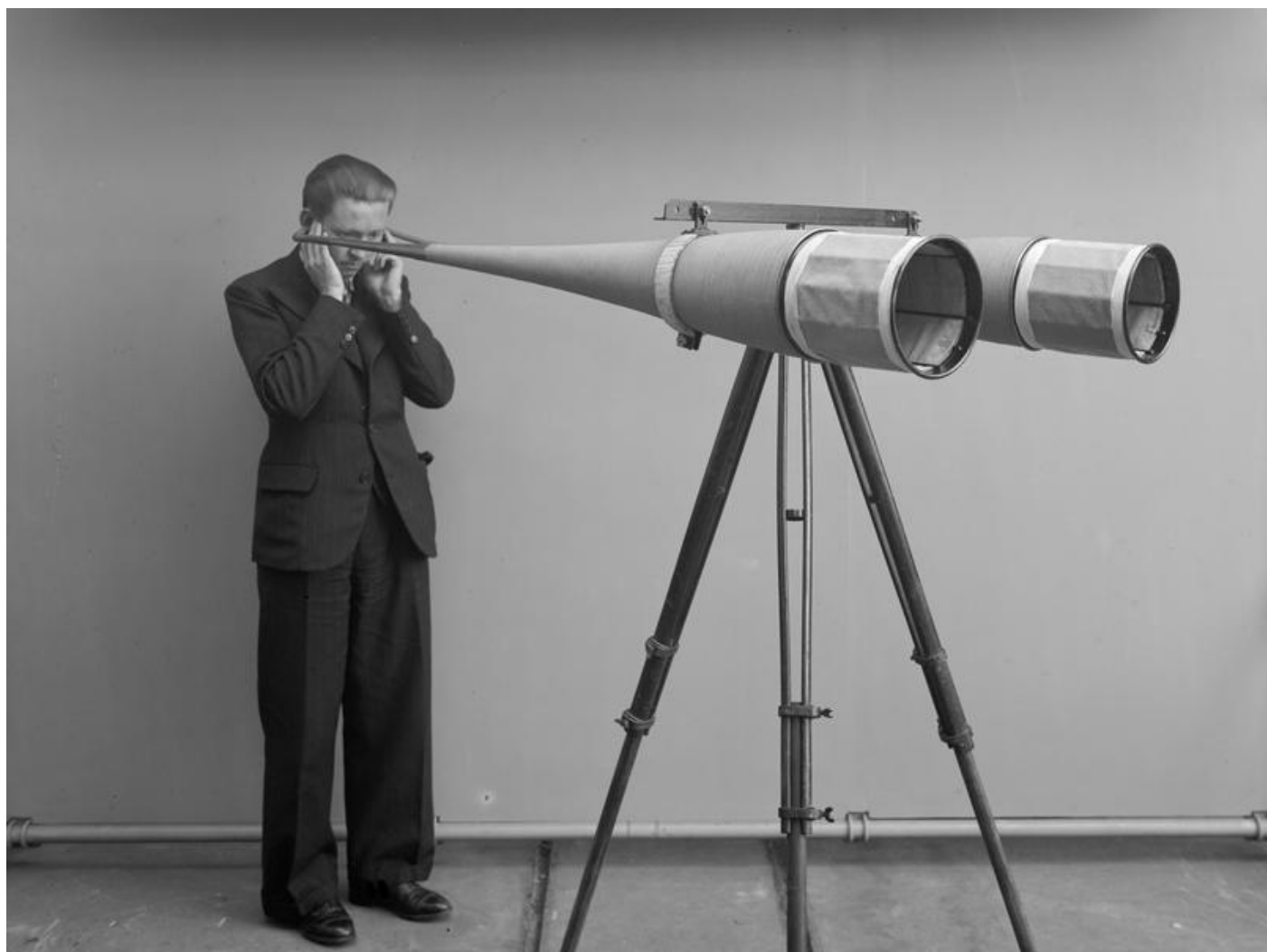
Office national des recherches scientifiques et industrielles et des inventions, Cornets acoustiques pour le repérage des avions de Georges Mabboux, 31 mai 1935. Collection CNRS, A_3264. (Exposition La Saga des inventions) - Crédits photo : Rencontres d'Arles
